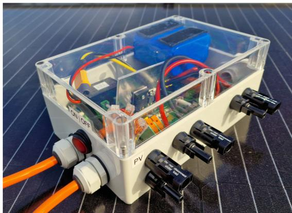
Abbildung 2: Das in dieser Arbeit entwickelte Kennlinienmessgerät IVCT.
